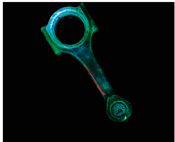
Figure 3 : Détection automatique par segmentation après ressuage fluorescent
