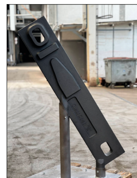
Démonstrateur Römheld & Moelle de la qualité issue du procédé ClearCast
